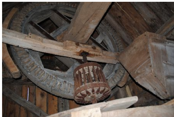
Södra kvarnen i Bårby har trelle med järnkuggar och en annorlunda utformning på kronhjulets kuggar för att passa dessa!
