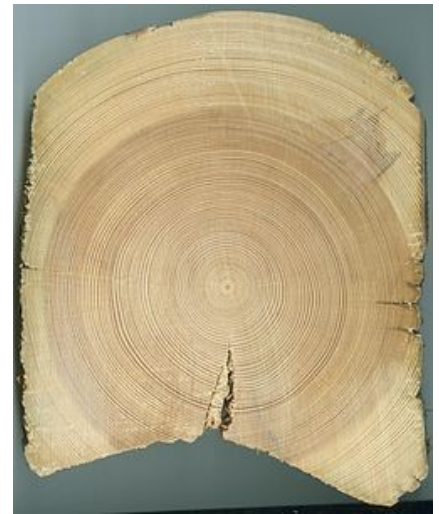
Prov DjBC03. Notera avsaknaden av blånad och sprickornas koncentration till långdraget (urtaget på undersidan)
