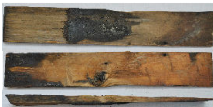
Spån 12 innan itusågning. 80 mm brett, varav 20 i splint. En större kvist i mittendelen har accepterats.
