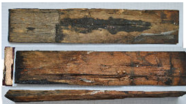
Spån 11 innan itusågning med tvärsnitt. 100 mm brett, taget ända till mærgen men obetydligt i splint. "Splittrighet" som skulle kunna förklaras med att man använt ett torrträd.
