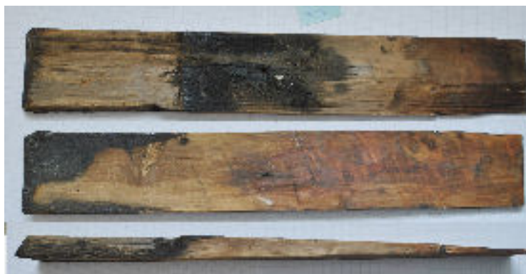
Spån 3 innan itusågning. 75 mm brett och med en mindre kvist i nedre delen. Man har använt en spik per spån, som satts i mitten, så att den även går igenom underliggande spån - i detta fall har spik genom nästa spån tagit i kanten på detta. Omkring tre mm ved har som synes vittrat bort.
